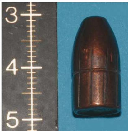
**Abb. 3** ▲ Das 9-mm-Spezialprojektil der niederländischen Polizei („Riquochet“-Projektil)
